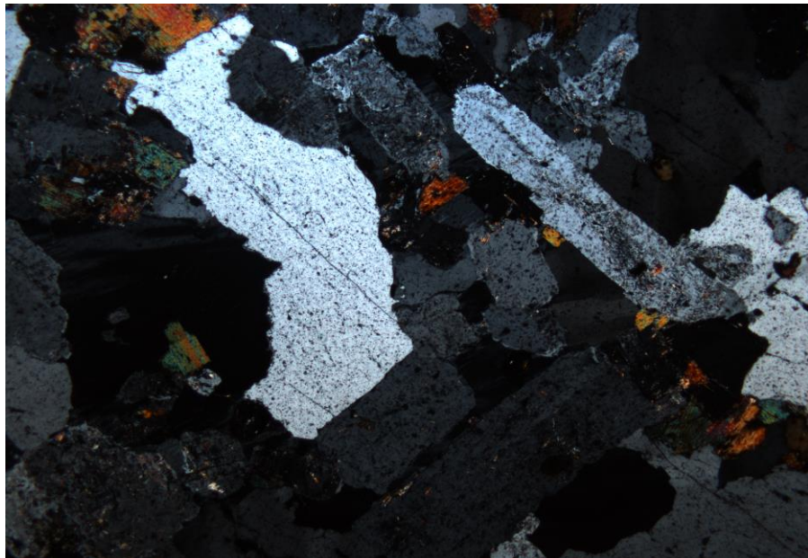
Fig. 4b – GPS 3 – Autre aspect de la structure grenue de l'échantillon GPS 3 à prismes de plagioclases gris clair et gris sombre, automorphes avec du quartz xénomorphe (en blanc). La biotite est en petits cristaux., associée à des grains d'épidote.
