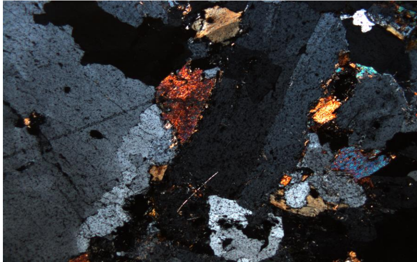
Fig. 3 – Cristal d'orthose (Fk) à macle simple de Carlsbad (au centre) entouré de cristaux de biotite et de plagioclases.
